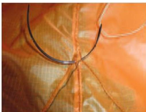
*Schnurkreuze zur Verstärkung der Waagepunkte*
