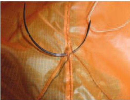
*Schnurkreuze zur Verstärkung der Waagepunkte*
