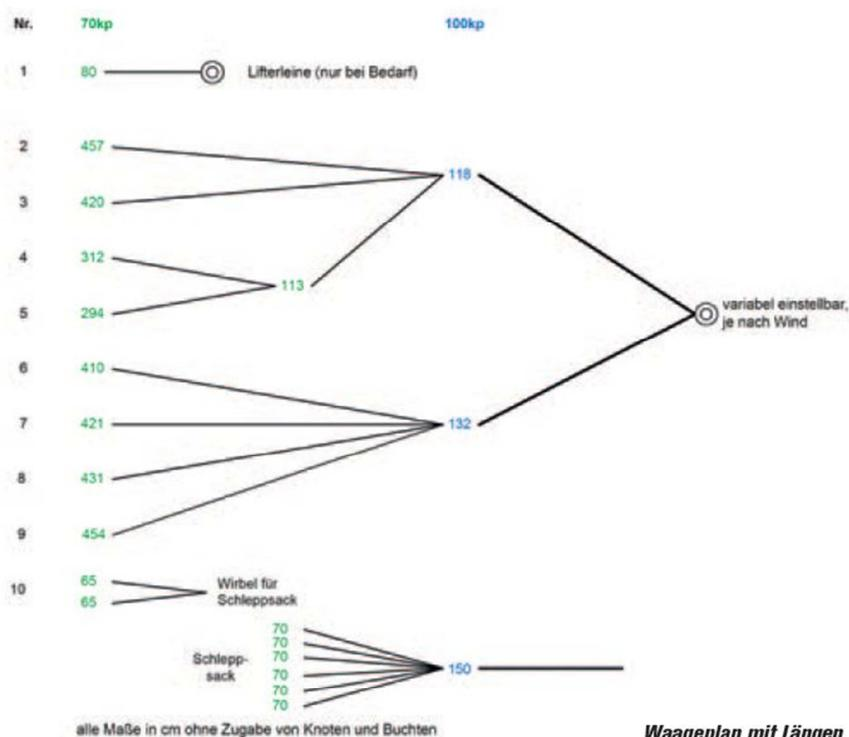
*Waageplan mit Längen*
