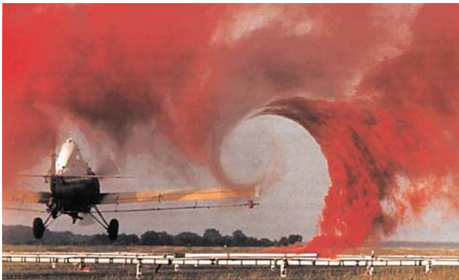
Fig. 22 Visualización de los torbellinos desprendidos del extremo de un ala
